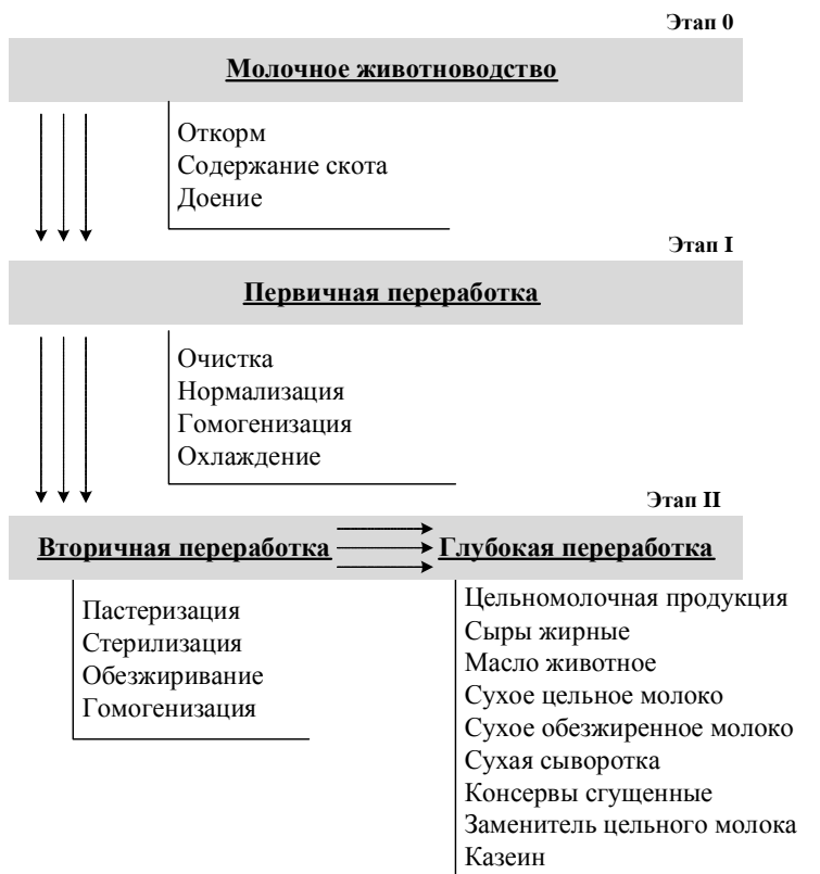
Рис. 1.10. Цепочка производства и технологической переработки молока
