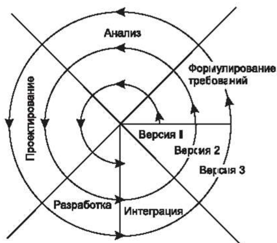
Рис. 19. Спиральная модель жизненного цикла системы
